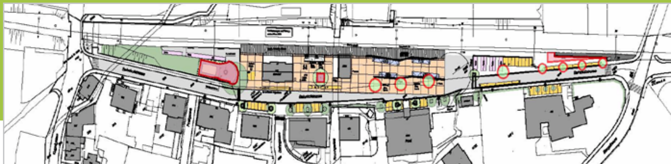
Situation mit Aufnahmegebäude, Kiosk und Perrondach sowie Bushaltekanten, gedeckten Veloabstellplätzen und Parkierung.
