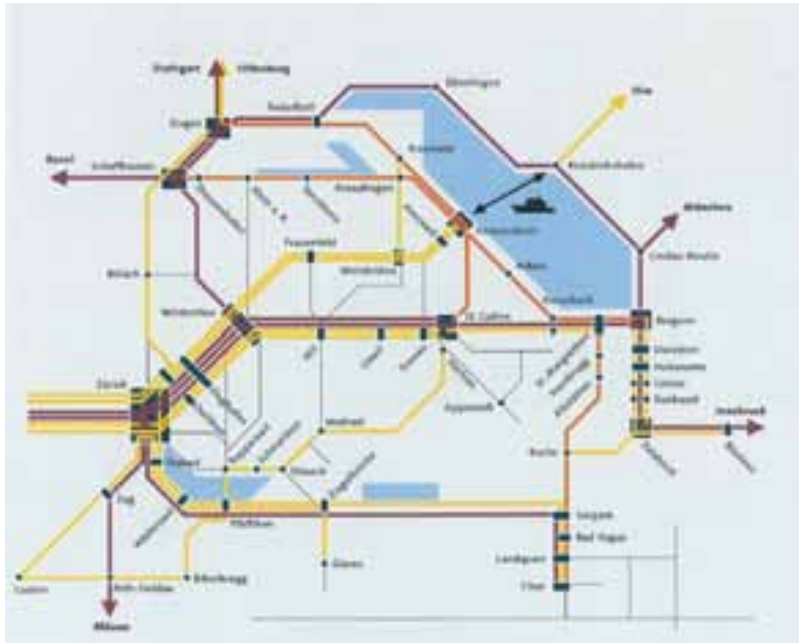
Abb. 2: IC-Züge ohne Halt (dunkelrot) verbinden die Knotenbahnhöfe. IR-Züge (gelb, hellrot) erschliessen die grösseren Zwischenstationen und bieten Anschlüsse an die IC-Züge in den Knoten.
